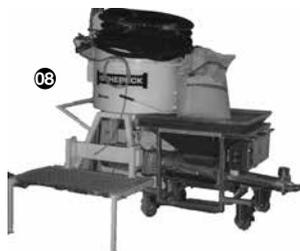
**08 Bomba de hélice para Drill Drain®** con mezclador de circulación forzada, con depósito de 80 l, ciclo 2 min. mínimo, capacidad 8 l/min, toma de corriente 380 V, toma de agua para manguera 1/2", unión de manguera e inyector de aire
