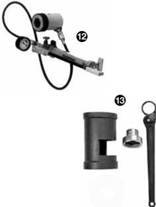
**12 Gato hidráulico**, manual, 326 kN de fuerza de tracción, émbolo con hueco de 33 mm de diámetro, carrera 63 mm, altura 178 mm, a 241 mm, incluido manómetro
