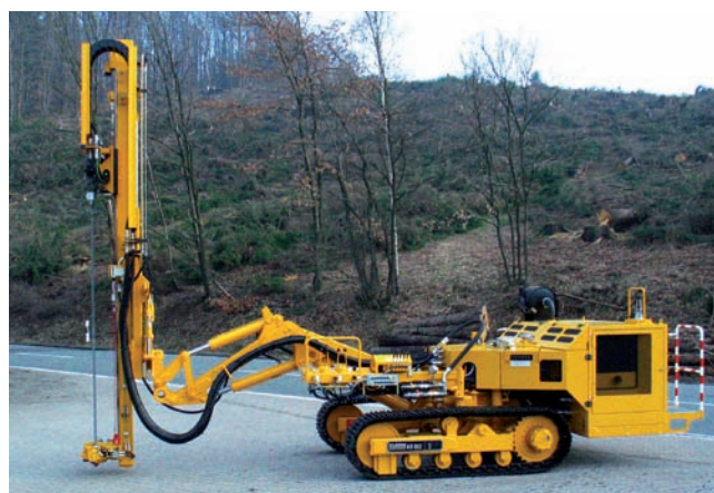
KR 802-3K erhöhte Reichweite durch Sondervorbau extended reach with special boom
